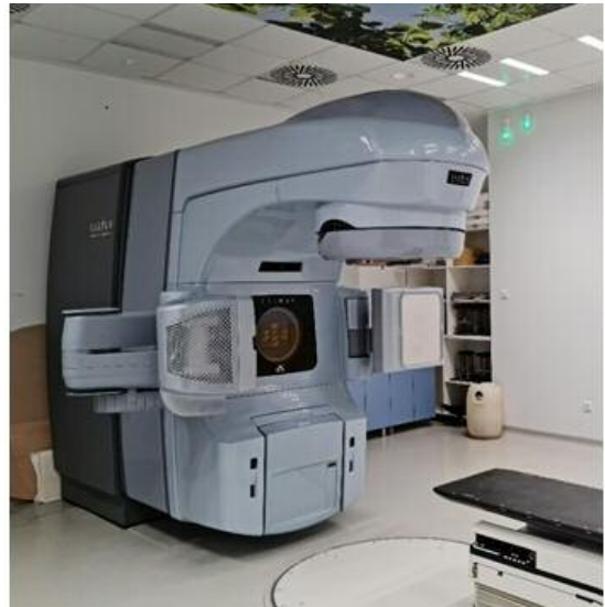
Слика 2. Један од линеарних акцелератора у Институту за онкологију и радиологију Србије на коме се могу спроводити 3D конформална, IMRT, VMAT или SBRT техника радиотерапије
